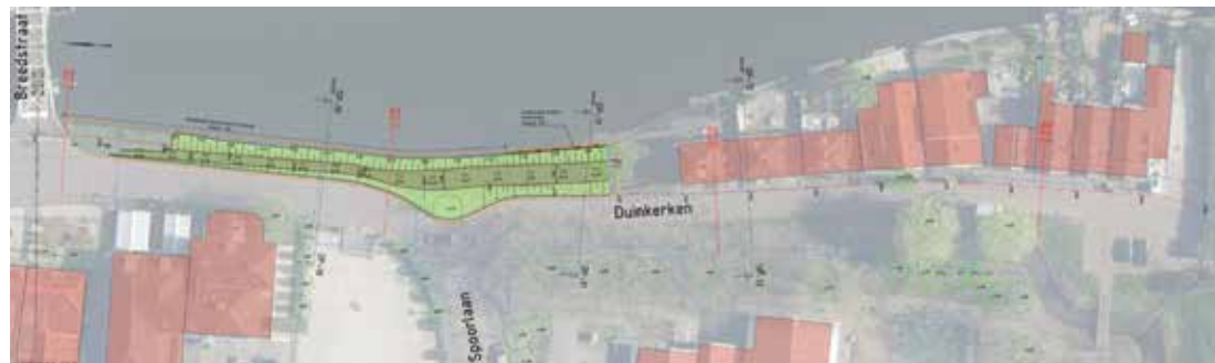
Afbeelding onder: Onderdeel van de ontwerptekening van de werkzaamheden. Groene vlakken: ophogen grond en aanleggen talud, groene cirkels: bestaande bomen handhaven.
